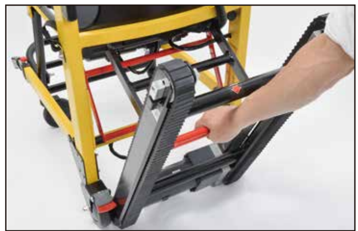
台車の背面にある走行ベルトは、キャタピラのような凸凹と滑りにくいゴムで、階段の段差でも昇り降りすることを可能にします。使用するとき、ゴムキャタピラ全体が階段に接地するように車椅子を傾けて進みます。
