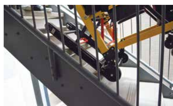
台車の背面にある走行ベルトは、キャタピラのような凸凹と滑りにくいゴムで、階段の段差でも昇り降りすることを可能にします。使用するとき、ゴムキャタピラ全体が階段に接地するように車椅子を傾けて進みます。
