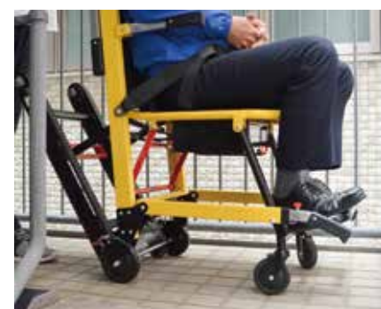
台車の背面にある走行ベルトは、キャタピラのような凸凹と滑りにくいゴムで、階段の段差でも昇り降りすることを可能にします。使用するとき、ゴムキャタピラ全体が階段に接地するように車椅子を傾けて進みます。
