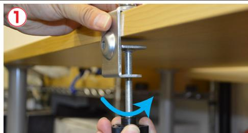
1 机の天板に「天板用クランプ」を挟み、ネジを回して固定します。
