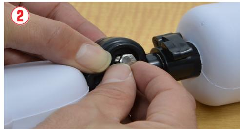
六角の溝がある方から、「手部のボルト」を差し込みます。ボルトの頭の六角がぴったしハマることを確認してください。
