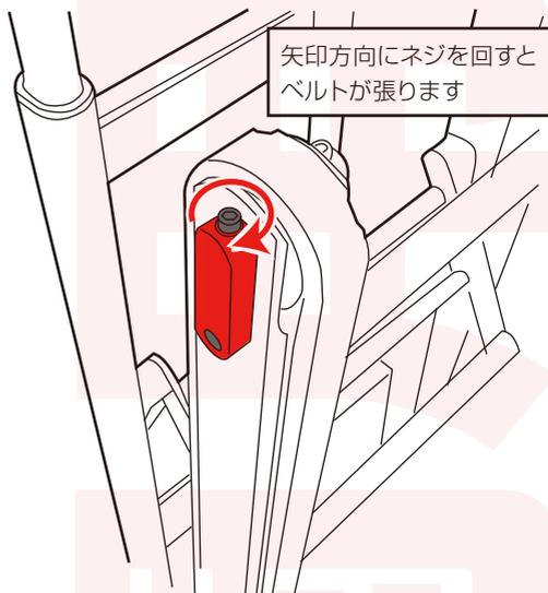
走行ベルトのテンションを確認します。本体を立て掛けた状態にしてください。走行ベルト側面上部にある赤い金属パーツのネジを回すことで、テンションを調整できます。4mm 六角レンチ（別途ご用意ください）を使用してください。
