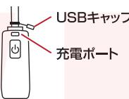
②USB-ACアダプタをコンセントに差し込み、充電ケーブルのUSB端子をUSB-ACアダプタに繋いで充電してください。(1A以上推奨)
