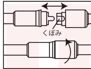
本体の先端部のくぼみにケーブルの突起部を合わせて奥まで挿し込み、本体のカバーを回転させてしっかりと締め込みます。
