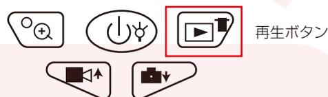
データを削除するには、削除したいデータが表示されている状態で再生ボタンを長押しします。確認メッセージなどは表示されませんのでご注意ください。
