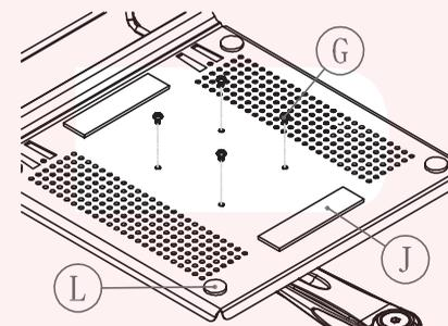
付属のGのネジを使って、ノートPCをのせる台をアームに取り付けます。LとJのシールを貼り付けて下さい。
