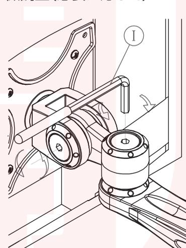
アームの関節部分が硬い場合は、必要に応じて、上図のように調整を行っていただけます。
