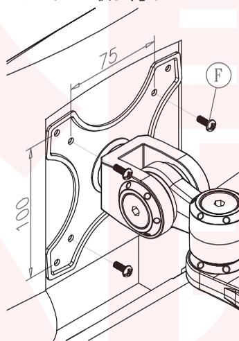
Fネジ4個でモニターを取り付けて下さい。
