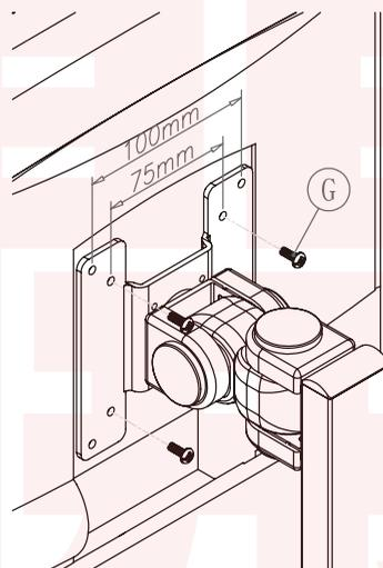
液晶モニター取り付け部分と液晶モニターを付属のネジ4本で固定します。(VESA規格75mm x 75mmまたは100mm x 100mmへ取り付け可能)
