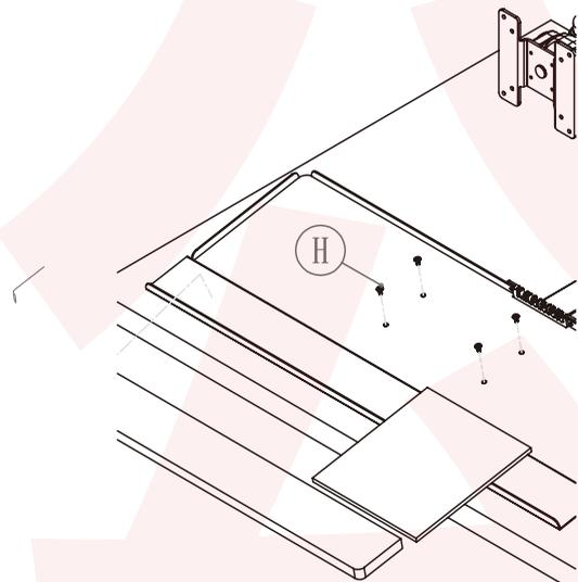
キーボード/マウス台 (図C) を付属のネジ4本で固定します。付属のマウスパッド、キーパッドを台にのせて下さい。キーボード/マウス台の右側に付属のドリンクホルダをネジ(D)2本で固定します。
