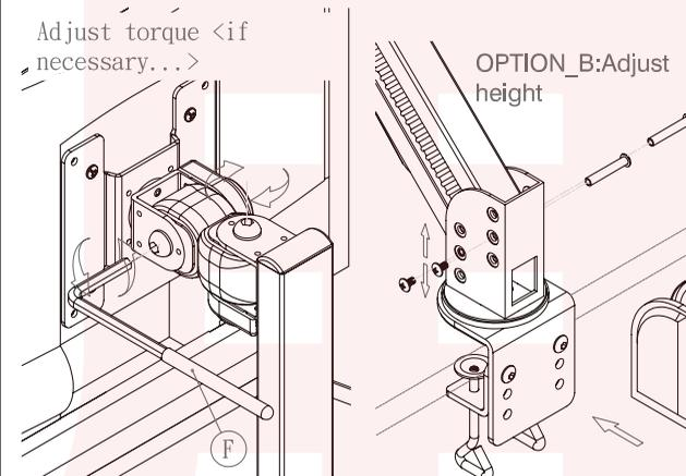
お好みに応じて、液晶取り付け部のトルク調整を使って行って下さい。クランプ部で高さ調整も可能です。
