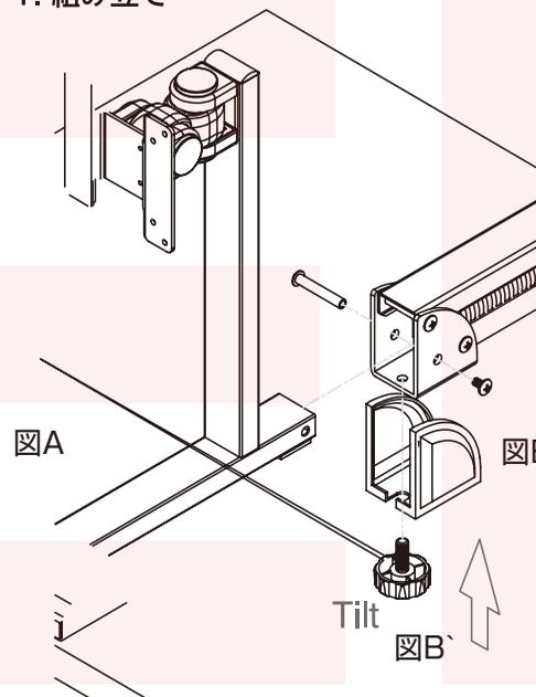
エクステンション部 (図B) のカバーを外して、ボルトを取り外して、L字型アーム本体 (図A) の突起部を接続します。
