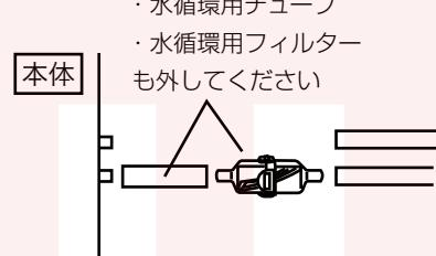
4 水循環用チューブから水を抜きます。チューブ出口をマットよりも低い位置にして排水してください。
