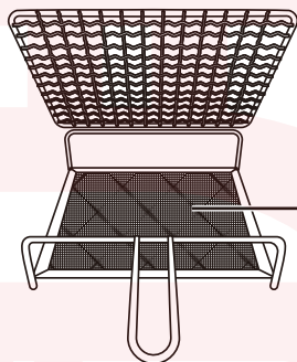
ヒーター接地部分
