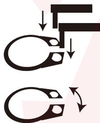
工具の先を穴に通し、輪を広げて外します。
