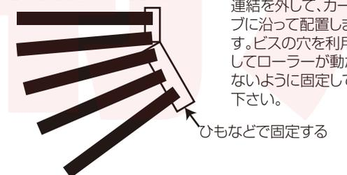
連結を外して、カーブに沿って配置します。ビスの穴を利用してローラーが動かないように固定して下さい。
