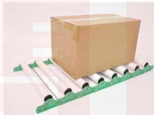
連結部を外し、1本1本を角度を付けて設置すると、カーブでもご使用頂けます。カーブ部のローラーは下に固定してお使いください。
