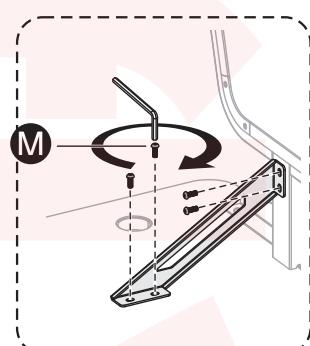
天板と足のねじ穴に、支柱(斜め)のねじ穴の位置を合わせて六角ねじを差し込み、六角レンチを使って全8箇所を固定します。
