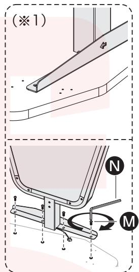
足の底4箇所に、ゴム足を差し込み、矢印の方向に回して取り付けます。天板と足のねじ穴の位置を合わせて六角ねじを差し込み、六角レンチを使って全8箇所を固定します。
