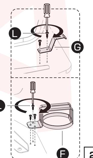
天板とドリンクホルダー及びヘッドホンホルダーのねじ穴の位置を合わせてプラスねじを差し込み、プラスドライバー(別売)を使って全5箇所を固定します。左右どちらのねじ穴側でも固定できますので、お好みの方に固定してください。
