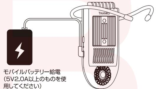
USBケーブルでモバイルバッテリーやUSB-ACアダプタに繋いだ場合、内蔵バッテリーの電力は消費しません。内蔵バッテリーの充電をしながらモバイルバッテリーやACアダプタ側から電力を給電します。
