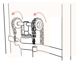
⑥台枠の穴にチェーン先端のネジを 通し、外したナットを留めます。
