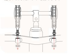
⑦留め金を再度ネジに差し込み、先端を開いて固定します。
