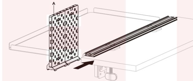
L: レール固定をレールの両端に差し込み、O: ネジ小で留めてください。
