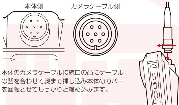
本体のカメラケーブル接続口の凸にケーブルの凹を合わせて奥まで挿し込み本体のカバーを回転させてしっかりと締め込みます。
