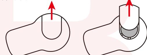
②コイン電池を外して新しいものと交換します。+極が見えるように電池を入れて、カバーを取り付けてください。
