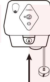
②タンクに中性洗剤を入れます。2倍~10倍程度の水で希釈して使用しますので、2.75L以下の量の洗剤を入れてください。
