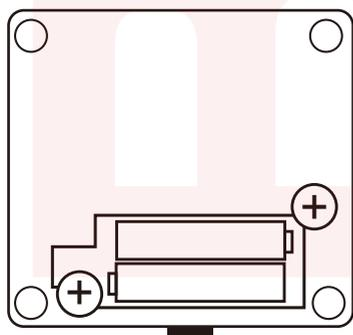
本体背面の電池蓋に爪をかけて、電池蓋を外します。
