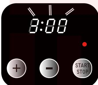
「ピッ」という音がし、液晶にタイマー時刻が点滅しながら表示されます。
