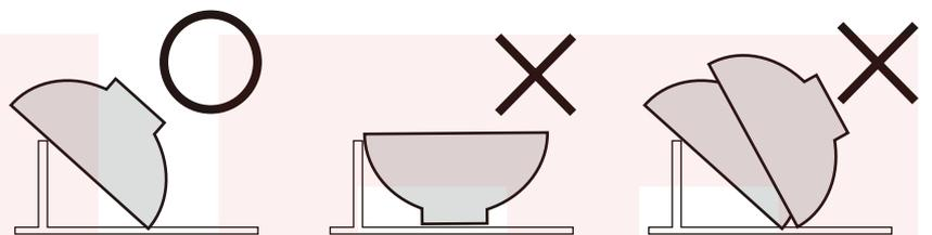
食器が隙間なく重なっていると、噴射水が届かないため十分な洗浄ができません。噴射水が当たるように隙間をあけてください。
