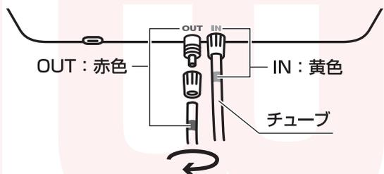
⚠ チューブから水が漏れないよう、しっかりとチューブカバーを締めてください。
