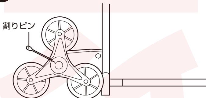
7 ラジオペンチで割りピンの先を開き、ポールに沿わせて3輪を固定します。
