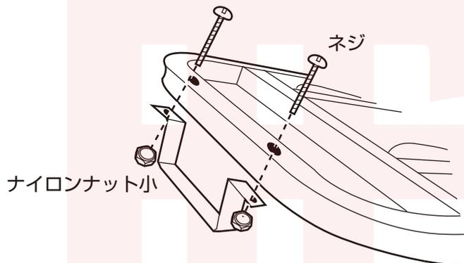
3 本体の荷台側を下にして置き、ベースを六角ネジ大とナイロンナット大で固定します。レンチなどで固定しながら、六角ネジ大をレンチなどで回してください。
